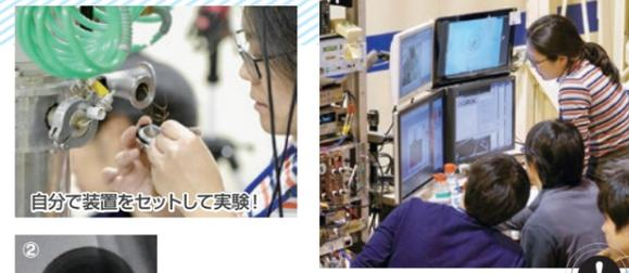
画像① 大型放射光実験施設SPring-8での実験風景です。超高温下で室温超伝導体の合成に挑戦しています。超高温下では酸素も金属になり超伝導になります。画像② ナノサイズのZnO(酸化亜鉛)の真球を作り、光を中に閉じ込め自在に操ります。画像③ 金の表面に規則正しく並べた分子の姿。分子を組み合わせ回路を創ります。
